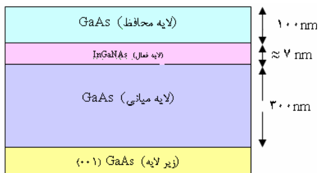
شکل ۱. طرح ساده‌ای از ساختار چاههای کوانتومی یگانه InGaAs/GaAs.
