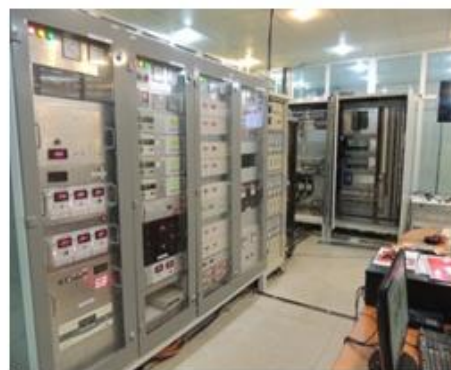
شکل ۶. شتاب‌دهنده پر قدرت صنعتی الکترون ساخته شده و بخشی از اتاق کنترل این شتاب‌دهنده.
