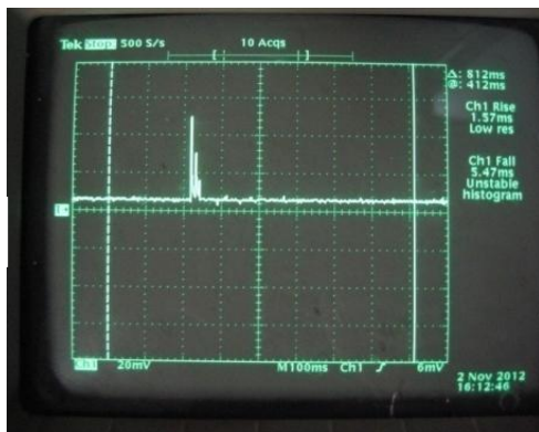
شکل ۷. الف) سطح نوسان و سیگنال کنترلی در زمان قطع و وصل، ب) سیگنال ارسالی مدار کروبار جهت قطع بسیار سریع منبع.
