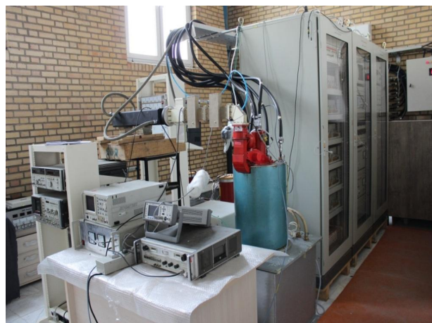
شکل ۷. اجزای مختلف مدولاتور پروژه شتاب‌دهنده خطی IPM.
