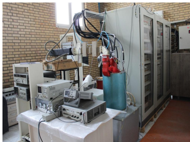
شکل ۷. اجزای مختلف مدولاتور پروژه شتاب‌دهنده خطی IPM.
