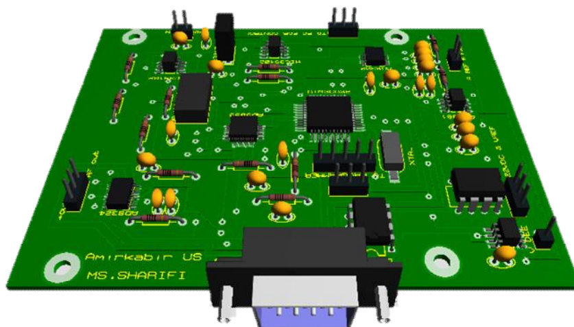
شکل ۹. صفحه مدار چاپی نهایی LLRF.
