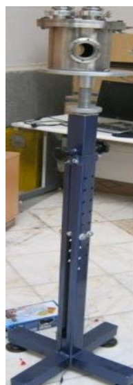
شکل ۶. نمایی از پایه ساخته شده برای نگهداری محفظه خلاء.
