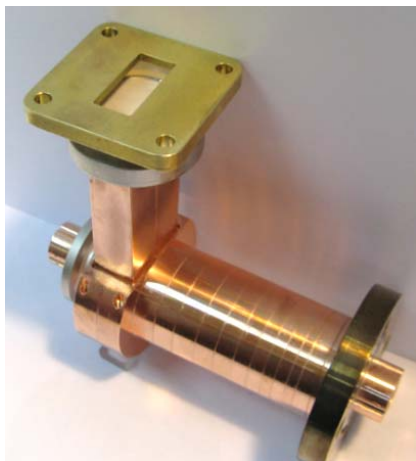
شکل ۶. ساختار کاواک‌ها پس از فرایند لحیم‌کاری.
