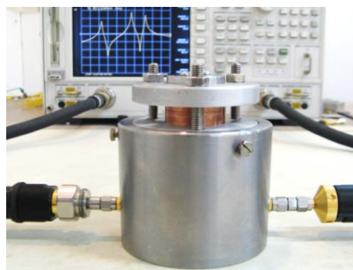
شکل ۷. نگهدارنده طراحی شده جهت اندازه‌گیری بسامد تشدید و ضریب کیفیت هر کاواک.
