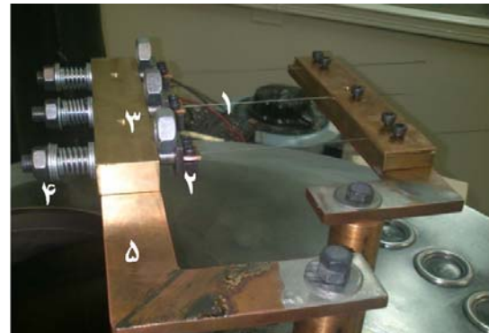
شکل ۴. تصویری از سیستم مکانیکی فنی نگهدارنده فیلمان نصب شده داخل محفظه خلأ (۱) فیلمان تنگستن، (۲) قطعه متحرک نگهدارنده فیلمان، (۳) صفحه برنجی، (۴) فنر و مهره، (۵) صفحه مسی.
