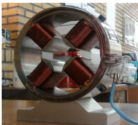
شکل ۸. مغناطیس چهار قطبی طراحی و ساخته شده برای پیش تزریق گر الکترون چشمه نور ایران.
