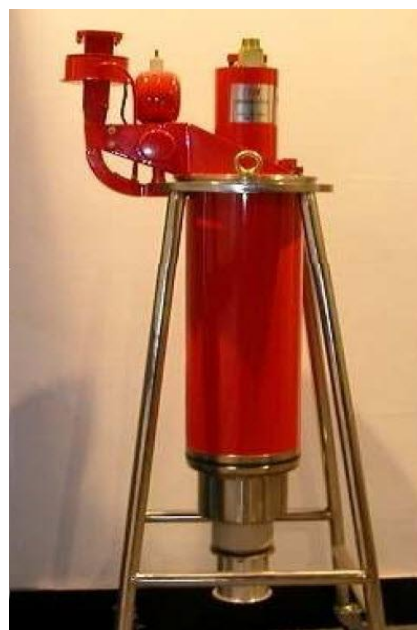
شکل ۶. لامپ توایسترون تهیه شده برای پروژه شتاب‌دهنده خطی IPM
