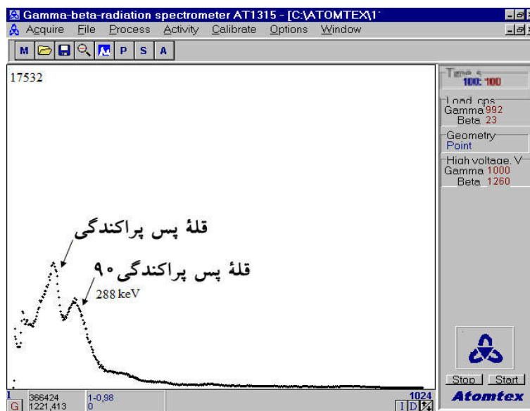
شکل ۴. (رنگی در نسخه الکترونیکی) طیف تجربی به دست آمده از فوتون‌های پراکندگی تحت زاویه ۹۰ درجه از نمونه آلومینیومی.
