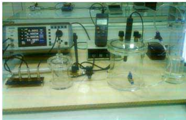
شکل ۱. تصویر سیستم تزریق رطوبت و اندازه‌گیری ویژگی‌های حسگری رطوبت.
