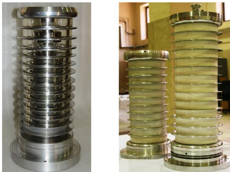
شکل ۵. ستون‌های شتابگر سرامیکی و شیشه‌ای ساخته شده.
