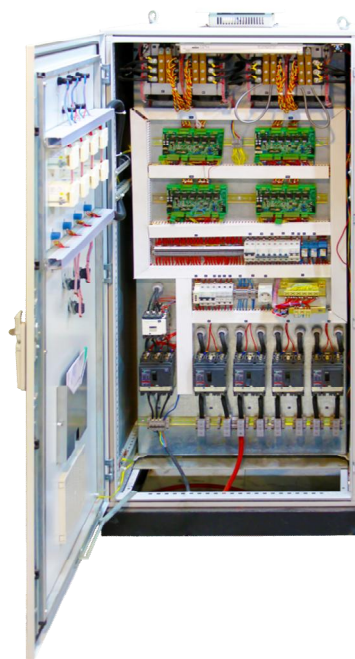
شکل ۵. منبع تغذیه ساخته شده در طرح چشمه نور.
