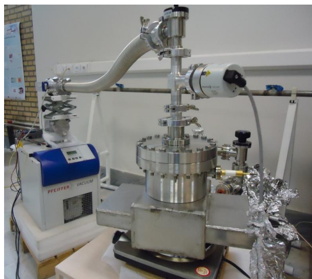
شکل ۱۱. پمپ یونی ساخته شده در طرح چشمه نور در حال آزمایش برای رسیدن به خلاء 10^{-1} تور.
