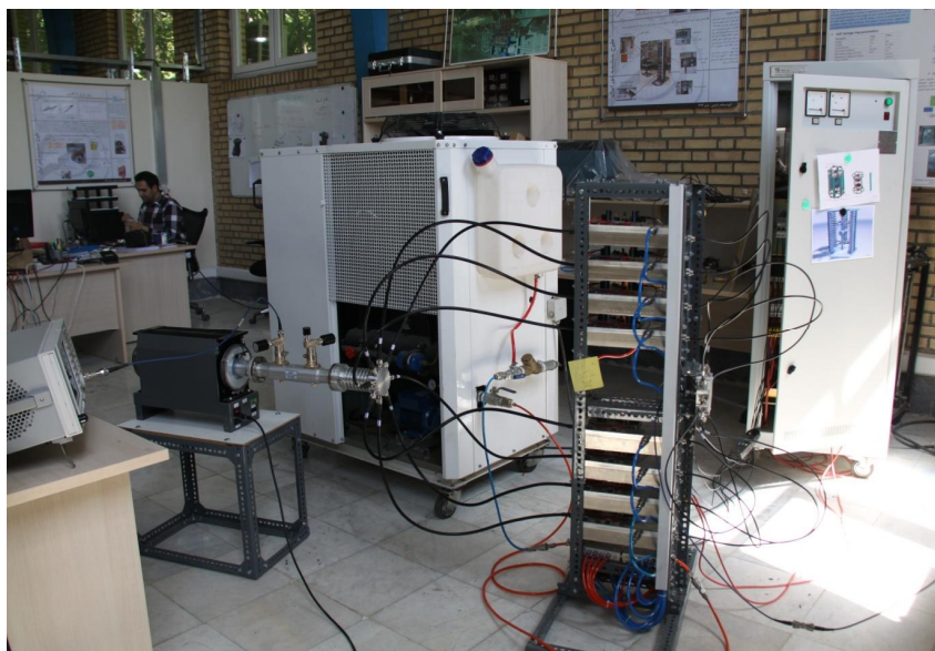
شکل ۸. تقویت کننده ۴ کیلووات ساخته شده در حال آزمون در آزمایشگاه بسامد رادیویی چشمه نور ایران.
