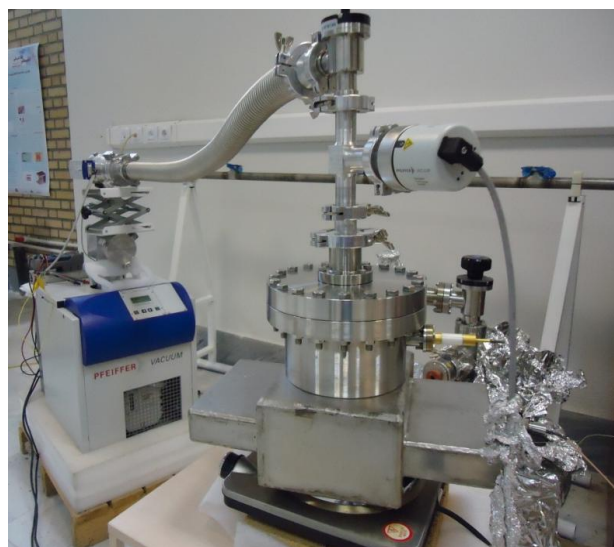
شکل ۱۱. پمپ یونی ساخته شده در طرح چشمه نور در حال آزمایش برای رسیدن به خلاء 10^{-10} تور.
