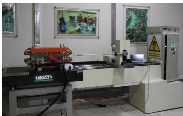
شکل ۴. سازه مکانیکی میز اندازه‌گیری هال (راست) و پیچۀ چرخان نمونه چشمه نور ایران (چپ).
