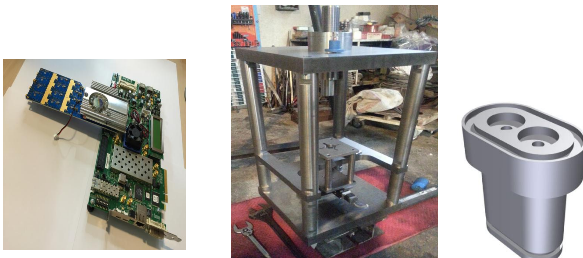
شکل ۱۰. نمونه طراحی شده مکان سنج دکمه‌ای مورد کاربرد در طرح چشمه نور ایران (راست). نمونه سامانه - آزمون طراحی شده جهت ارزیابی مکان سنج‌ها قبل از نصب آنها در حلقه باریکه در طرح چشمه نور ایران (چپ).
