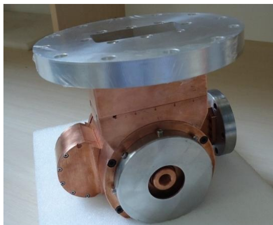
شکل ۴. نمونه اولیه تفنگ الکترونی بسامد رادیویی ساخته شده در چشمه نور ایران.
