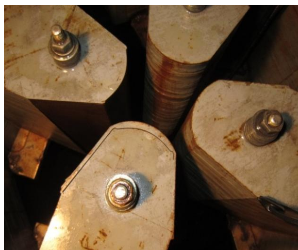
شکل ۸. نمونه برشکاری شده توسط دستگاه سیم برش.
