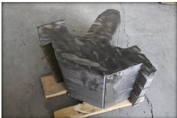
شکل ۷. هسته یکپارچه بعد از پخت.
