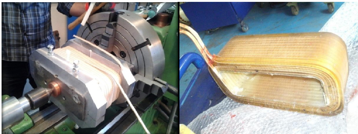
شکل ۹. پیچیدن کویل روی نگهدارنده توسط دستگاه تراش (چپ) سیم پیچ آماده شده بعد از عملیات VPI (راست).
