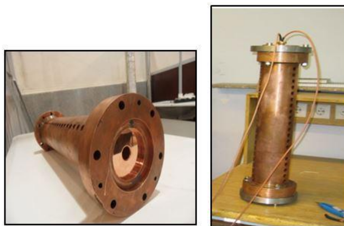
شکل ۱۲. تیوب ساخته شده پس از مرحله مونتاژ.
