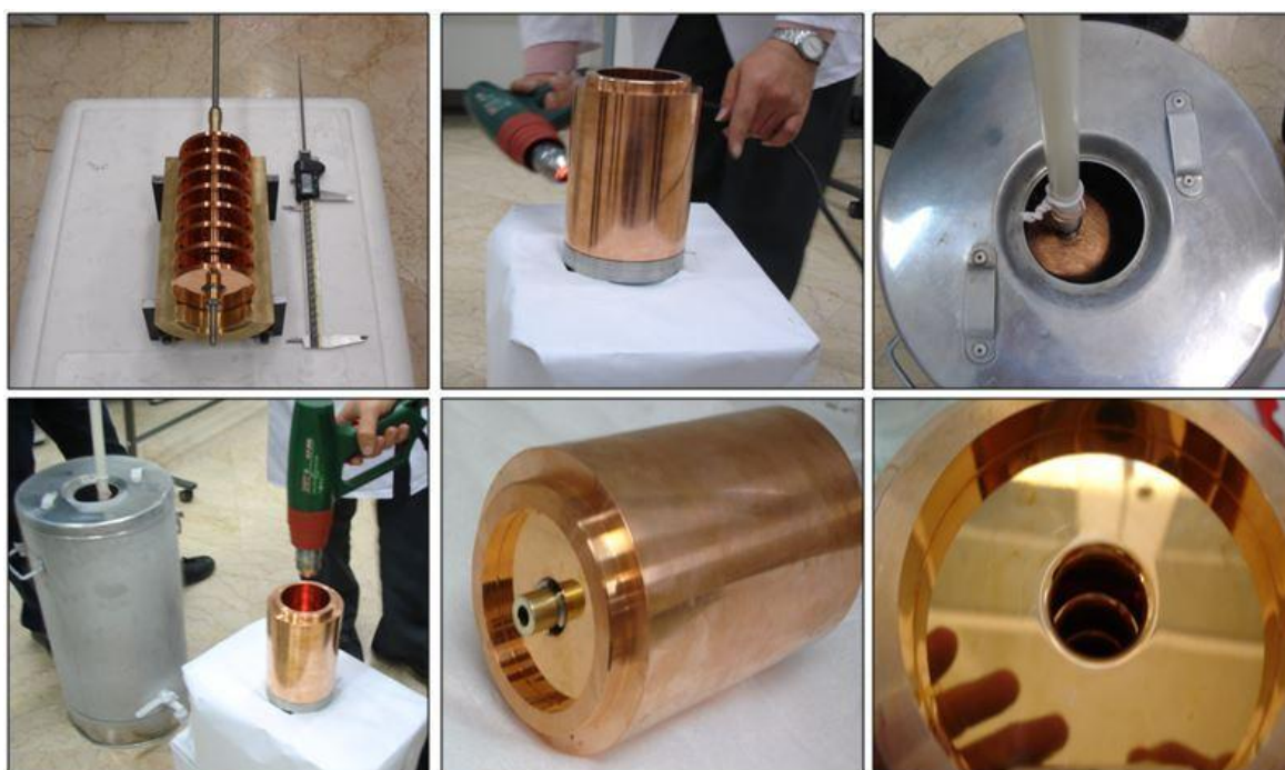
شکل ۱۰. نحوه سرد کردن دیسک‌ها و مونتاژ قطعات برای تیوب با ۸ کاواک.
