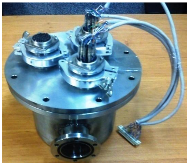
شکل ۵. ساخت نهایی محفظه SEM برای نصب بر روی شتاب دهنده ES-۲۰۰.
