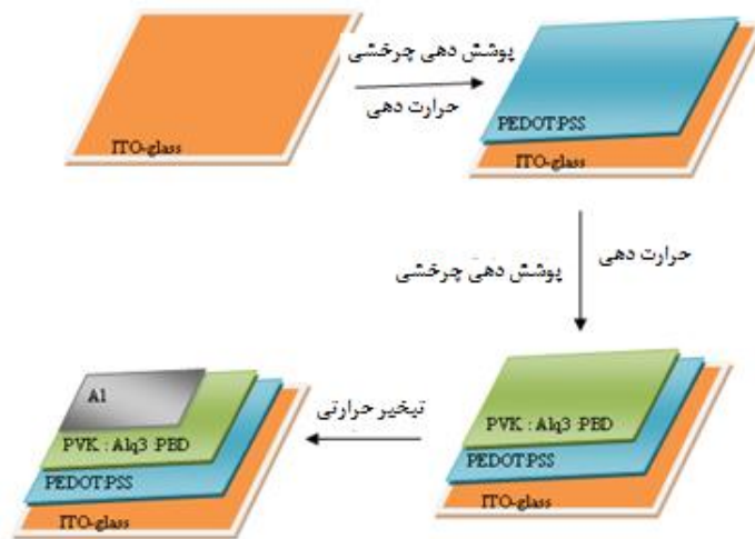
شکل ۶. (رنگی در نسخه الکترونیکی) دیود آلی با ساختار ITO/PEDOT:PSS/PVK:Alq 3 :PBD/Al.
