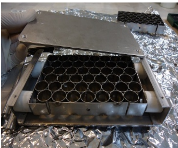
شکل ۱۳. اتصال سلول‌ها پنینگ و صفحات کاتد به یکدیگر.
