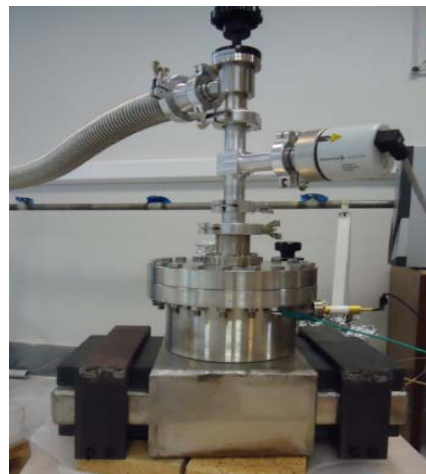
شکل ۱۴. پمپ یونی ساخته شده در شتاب دهنده ملی ایران.
