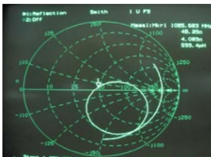
شکل ۴. تطبیق امپدانس درگاه خروجی با نمودار اسمیت.
