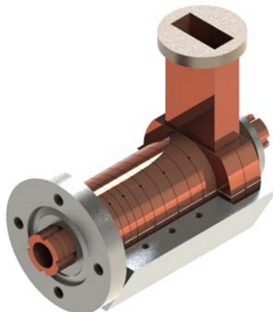
شکل ۵. طرح قید و بند مورد استفاده جهت هم محوری کاواک‌ها.
