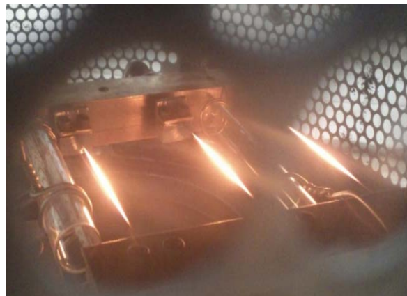
شکل ۵. تصویری از فیلمان‌های گداخته هنگام عبور جریان و گسیل الکترون.
