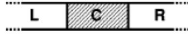
شکل ۱. نانو ساختار متشکل از یک رسانای محدود (C) که دو الکترون چپ و راست را از هم جدا کرده است.
