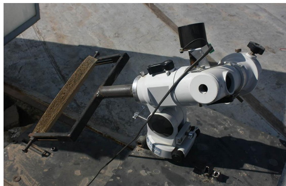
شکل ۳. (رنگی در نسخه الکترونیکی) محور آینه در امتداد ستاره قطبی.
