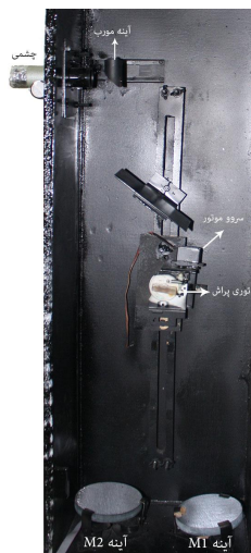
شکل ۱۲. (رنگی در نسخه الکترونیکی) نمایی از دو آینه و توری پراش.
