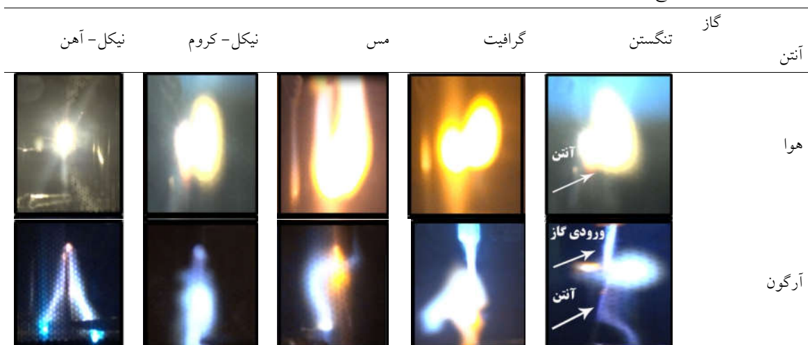
جدول ۱. گوی پلاسمای موج میکرو تولید شده در مجاورت هوا و گاز آرگون.
