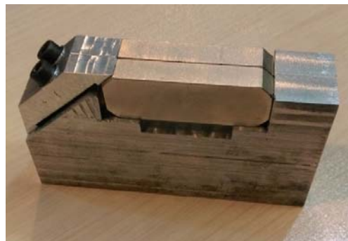
شکل ۱۶. (رنگی در نسخه الکترونیکی) بستن دو آهنربای دائمی در یک نمونه اولیه فک برای ارزیابی نحوه عملکرد سازوکار بستن آهنرباها.
