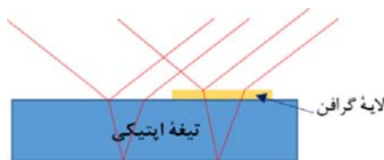
شکل ۷. (رنگی در نسخه الکترونیکی) طرحواره تداخل از تیغه اپتیکی با و بدون لایه گرافنی.
