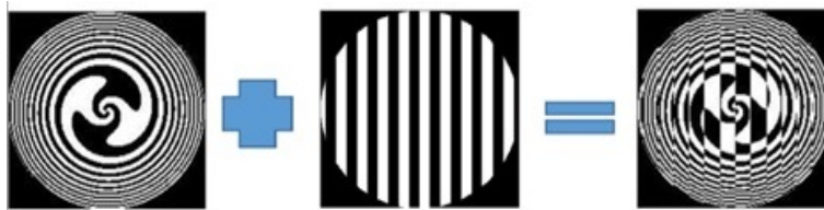
شکل ۲. تغییر ساختار تیغه منطقه‌ای و تولید المان پراشی نوین به عنوان عنصر آرایه‌ساز.
