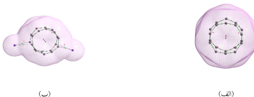
شکل ۳. (الف) نانولوله کربنی زیگزاگ (۵,۰) و (ب) نانولوله کربنی زیگزاگ (۵,۰) با استفاده از تغلیظ دو پتاسیم، با شرط مرزی دوره‌ای در سطح محاسباتی PBE/PBE/6-31G(d) حاصل از محاسبات QAIM.
