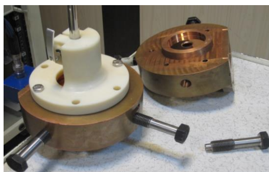
شکل ۴۰. (رنگی در نسخه الکترونیکی) حفره‌های روی بدنه تزویجگر و پیچ‌هایی برای ایجاد تغییر شکل در سطح داخلی کاواک.
