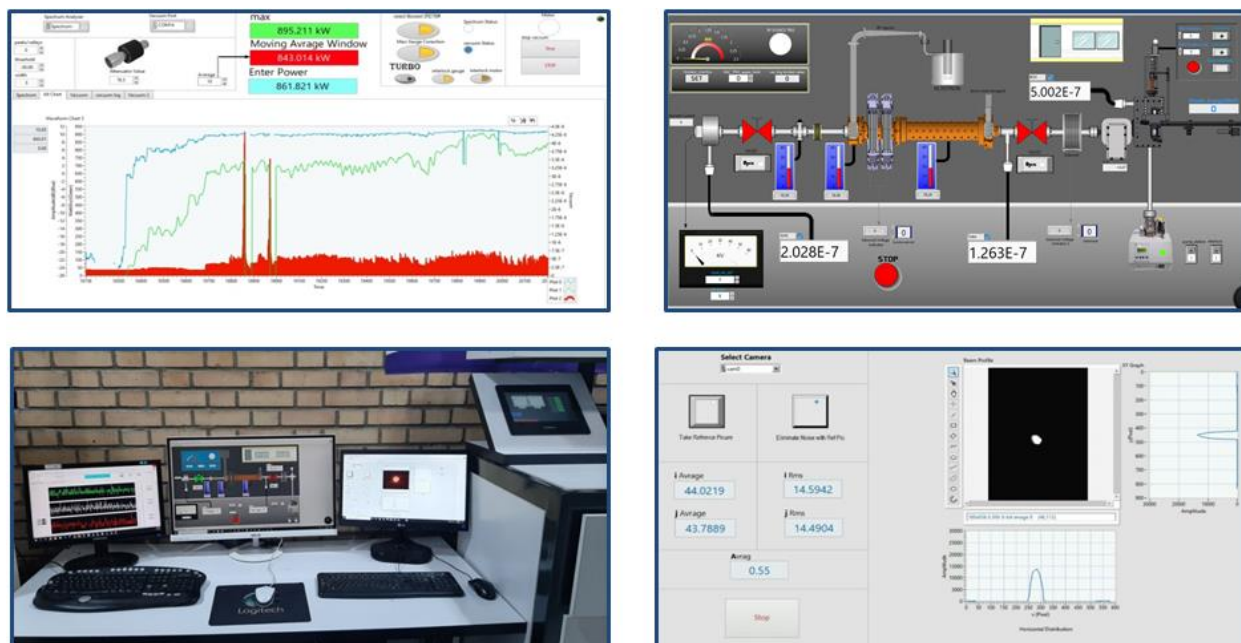
شکل ۴۵. (رنگی در نسخه الکترونیکی) میز کنترل (پایین سمت چپ) صفحه نمایش شتاب‌دهنده و اتصالات آن (بالا سمت راست)، صفحه نمایش خلا‌ها و توان بسامد رادیویی (بالا سمت چپ) و باریکه و نیم‌رخ آن (پایین سمت راست).
