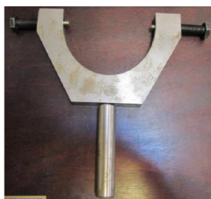
شکل ۲۳. (رنگی در نسخه الکترونیکی) برخی از ابزارهایی که برای ایجاد تغییر شکل در جدار داخلی سلول‌ها ساخته شدند.
