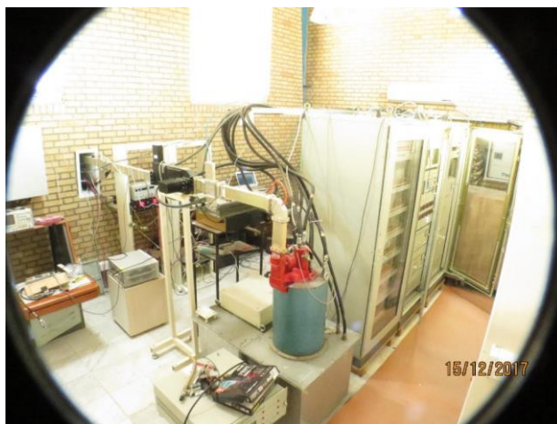
شکل ۴۴. (رنگی در نسخه الکترونیکی) مجموعه تولید توان بالای بسامد رادیویی شتاب‌دهنده خطی (کابینت‌های سمت راست مدولاتور، لامپ به رنگ قرمز، سیملوله کانونی کننده به رنگ آبی و موجرها کاملاً مشخص‌اند).
