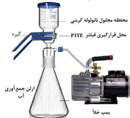
شکل ۱. طرح‌واره سامانه تولید باکی کاغذ.
