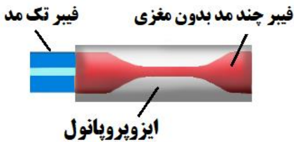
شکل ۴. شماتیک کلی حسگر دمایی فیبر نوری. دلیل استفاده از رنگ‌های آبی و قرمز، صرفاً جهت نمایش بهتر قطعات مختلف حسگر است.
