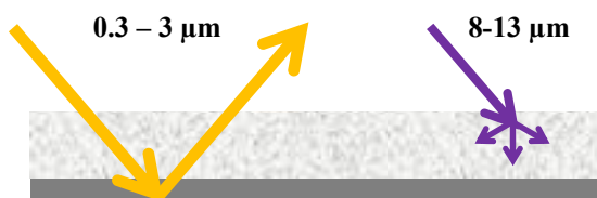
شکل ۲. ساختار سرمایش تشعشعی چندلایه
