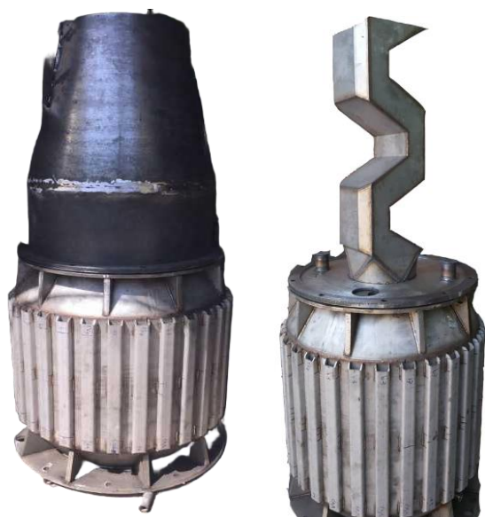
شکل ۶. هندسه و محل قرارگیری ماریپچ پلکانی ساخته شده.
