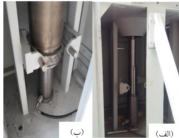
شکل ۳. موقعیت جک در حالت (الف) روشن (جک در پایین‌ترین حالت ممکن است) و (ب) خاموش (جک تا انتها باز است). استوانه سربی خاموش/روشن توسط میله‌های نگهدارنده مهار شده و بار استوانه سربی از روی جک برداشته شده است.
