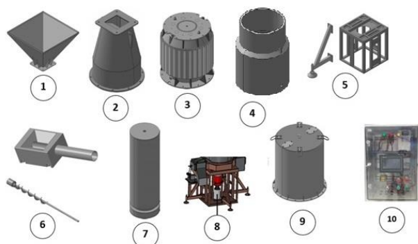
شکل ۲. اجزای اصلی سامانه پرتودهی خود حفاظت گاما شامل (۱) قیف ورودی، (۲) مارپیچ بالایی، (۳) کسک پرتودهی، (۴) تنوره، (۵) پایه، (۶) ماردون پیچشی و کالسکه، (۷) استوانه روشن/خاموش سربی، (۸) جک هیدرولیکی، (۹) محفظه حمل کسک و (۱۰) تابلوی فرمان.
