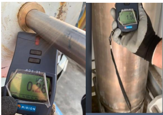
شکل ۱۲. دزیمتری بخش‌های مختلف سامانه خودحفاظ گاما
