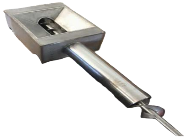
شکل ۴. ماردون با هر بار چرخش حجم مشخصی از محصولات غذایی پرتو دیده را به خارج کسک هدایت می کند.
