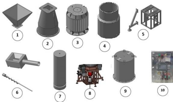
شکل ۲. اجزای اصلی سامانه پرتودهی خود حفاظ گاما شامل ۱) قیف ورودی، ۲) ماریچ بالای، ۳) کسک پرتودهی، ۴) تنوره، ۵) پایه، ۶) ماردون پیچشی و کالسکه، ۷) استوانه روشن / خاموش سربی، ۸) جک هیدرولیکی، ۹) محفظه حمل کسک و ۱۰) تابلو فرمان.
