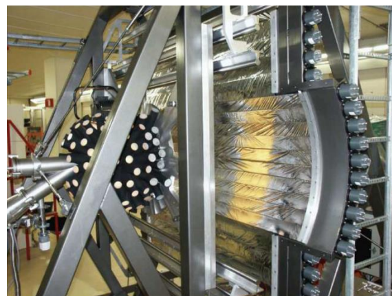
شکل ۱. چیدمان BINA با نمایش آشکارسازهای سوسوزن ۱۲ سانتی‌متری روی یک قطاع استوانه و توپی عقبی با ۱۴۹ آشکارساز به عنوان محفظه پراکندگی.
