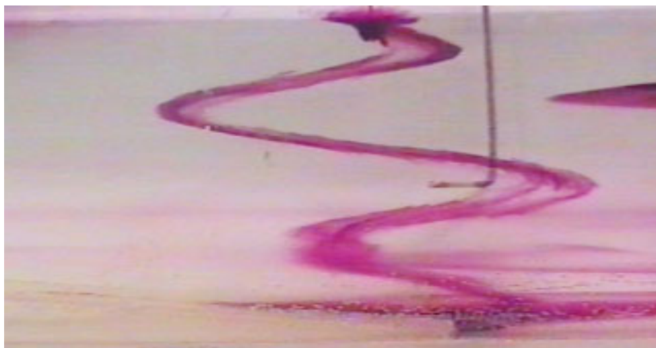
شکل ۱۱. تصویری از لایه‌های برشی ایجاد شده در آزمایشگاه توسط پلوم سرازیر شده از روی شیب درون مخزن [بیدختی و نوروزی، ۲۰۰۴].
