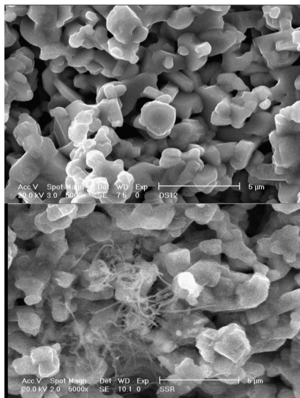
شکل ۴. تصاویر SEM نمونه‌های بدون آرایش (بالا) و با آرایش CNT (پایین).
