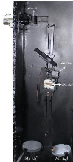
شکل ۱۲: نمایی از دو آینه و توری پراش
