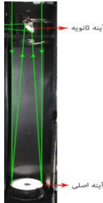
شکل ۶: مسیر حرکت نور در تلسکوپ
