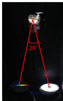
شکل ۱۱: زاویه بین پرتو فرودی و بازتابی
