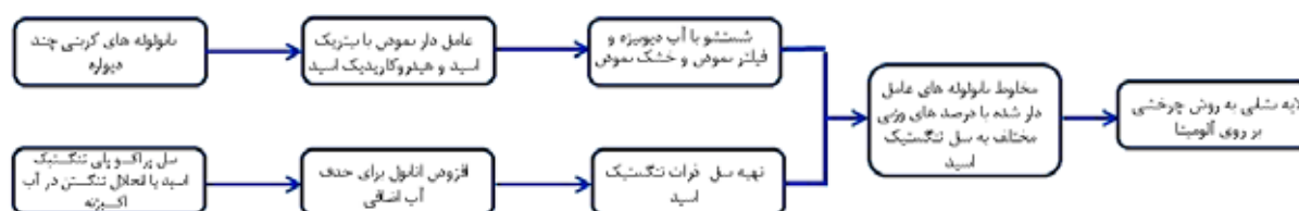
شکل ۱. به طور نمادین مراحل ساخت لایه‌های نازک هیبریدی را نشان می‌دهد.
