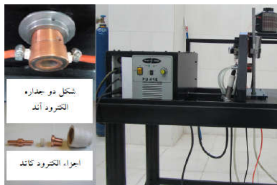
شکل ۳. (رنگی در نسخه الکترونیکی) عکس مشعل پلاسمایی و الکتروودهای آند و کاتد.
