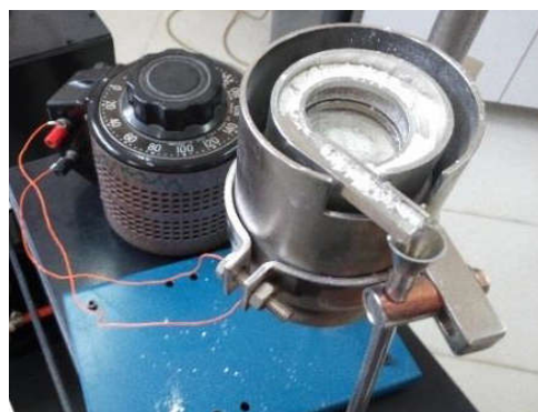
شکل ۱. (رنگی در نسخه الکترونیکی) ارتعاشگر انتقال پودر به همراه واریاک.
