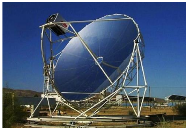
شکل ۱. آینه متمرکز کننده دیش اروپایی در مرکز پژوهشی پی‌اس‌ای (اسپانیا) با دو محور ردیابی سمتی و فرازی (ارتفاعی) [۵].
