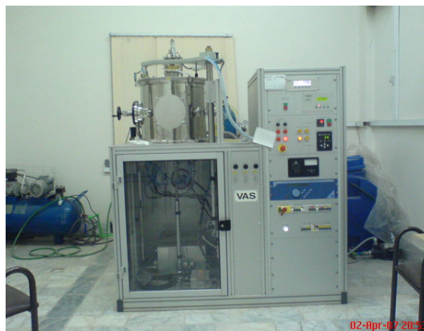
شکل ۱. دستگاه لایه‌نشانی تبخیر حرارتی در خلأ، مورد استفاده در این تحقیق.
