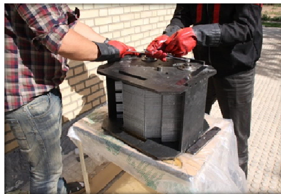
شکل ۶. چیدن ورق‌های آغشته به رزین در درون نگهدارنده فشرده سازی.
