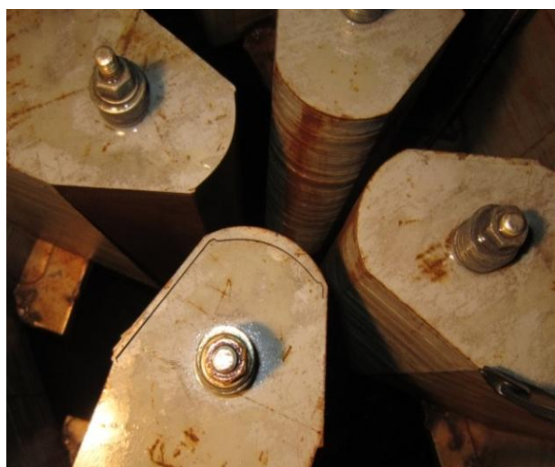
شکل ۸. نمونه برشکاری شده توسط دستگاه سیم برش.
