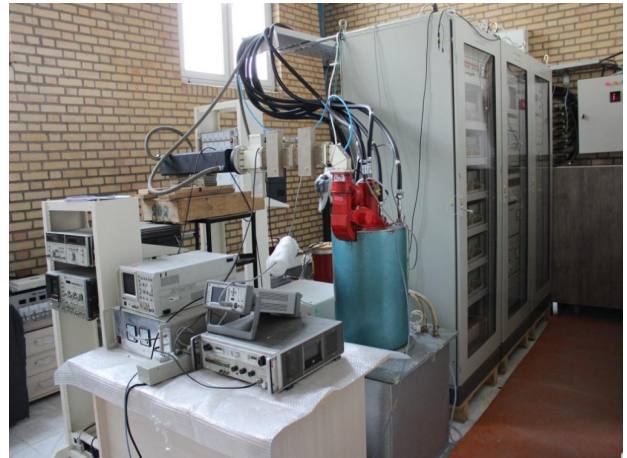
شکل ۷. اجزای مختلف مدولاتور پروژه شتاب‌دهنده خطی IPM.
