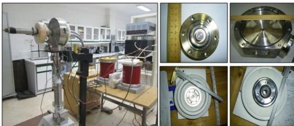
شکل ۳. کاتد، محفظه آند و سیستم‌های الکترونیکی تفنگ الکترونی مورد نظر.
